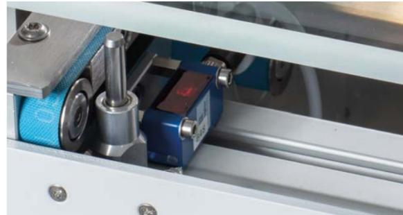
Die Position des Prüflings steuert den Ablauf. Dadurch erreicht die ITS eine variable Durchsatzgeschwindigkeit und passt sich automatisch dem Linientakt an.
